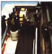
La parte di supporto della carta, in alto la più grande ruota che ha il movimento di rotazione durante la stampa.
